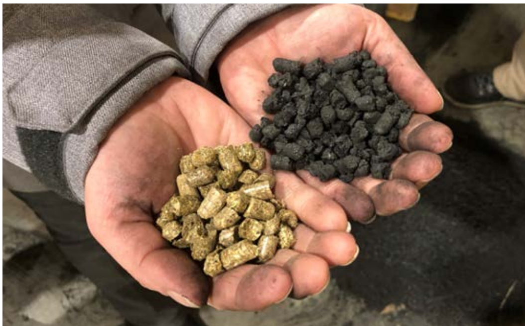
Figur 4.3. Träpellets före och efter pyrolys vid tillverkning av biokol. Foto: Lina Pettersson
